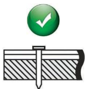
Рис. 2 Пример правильной забивки гвоздей при монтаже продукции.
